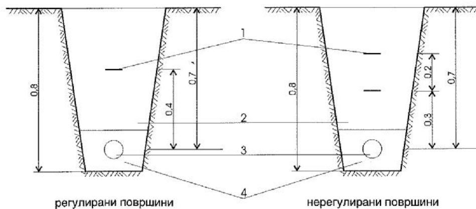
Слика 2-16. Полагање на НН кабел на рагулирани и нерегулирани површини
